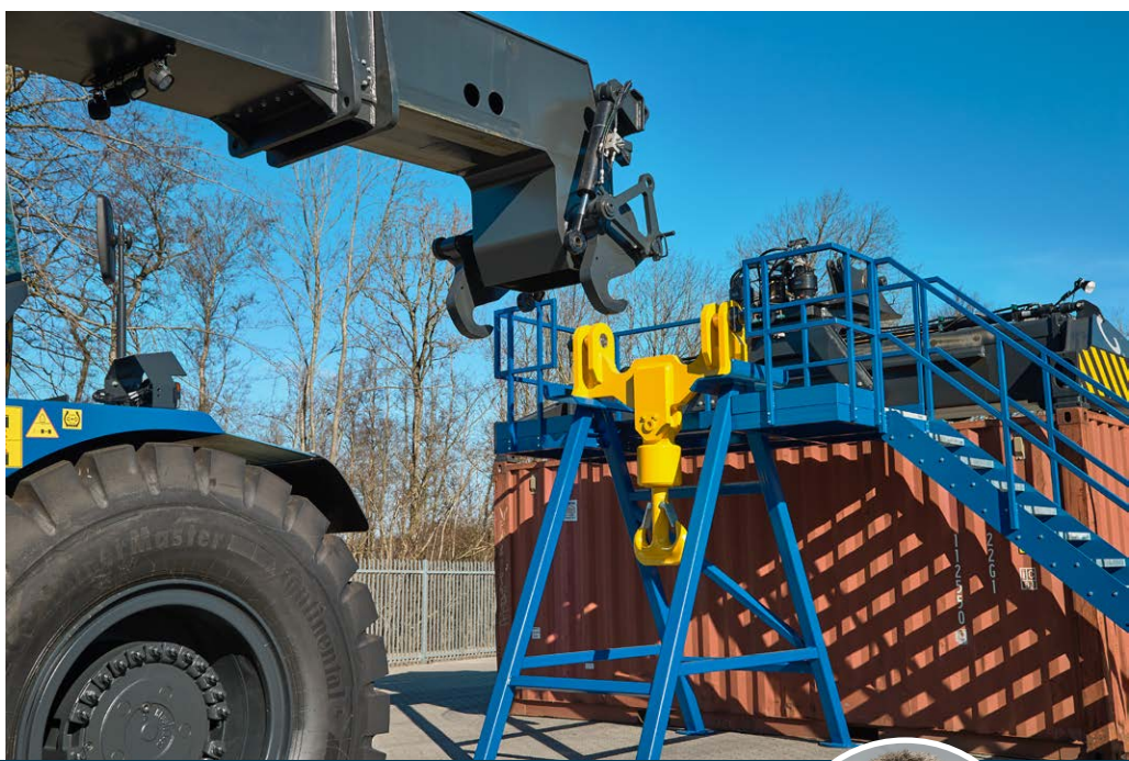
N.C. Nielsen har udviklet en Quickshift-løsning til reachstackere i kategorien 85 til 110 ton, der gør muligt at skifte mellem en krog og et containeråg på omkring 15 minutter.
