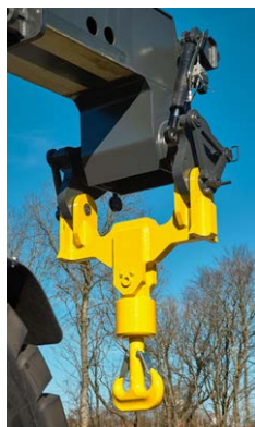
N.C. Nielsen har udviklet en Quickshift-løsning til reachstackere i kategorien 85 til 110 ton, der gør muligt at skifte mellem en krog og et containeråg på omkring 15 minutter.
